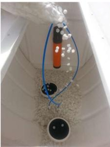
Paso 3: Sedimentador, por medio de unos agujeros en la parte inferior, el agua tratada es enviada al último paso, el cual agarra el agua tratada y permite que los lodos activados se queden en el fondo del tanque, para ser reprocesados, y por medio de un tubo colector, el agua tratada es sacada de la planta para su disposición final.
