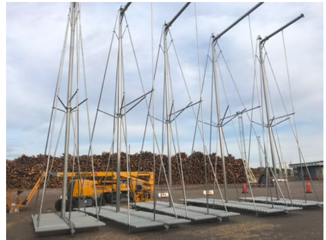
Sistemas izables con grúa con difusores de disco (a la izquierda) y tubulares (a la derecha)
